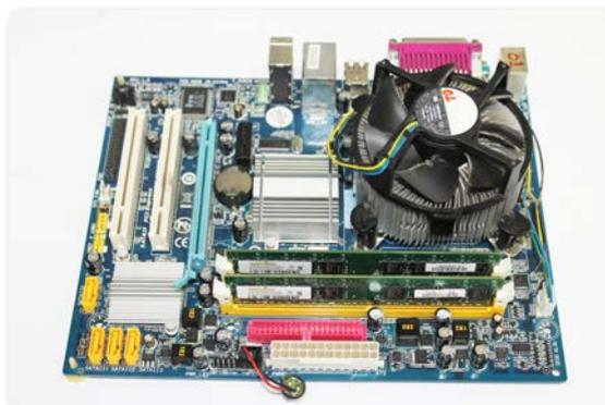
As placas-mãe são desenvolvidas de forma que seja possível conectar todos os dispositivos que compõem o computador. Para isso, elas oferecem conexões para o processador, para a memória RAM, para o HD, para os dispositivos de entrada e saída, entre outros.
