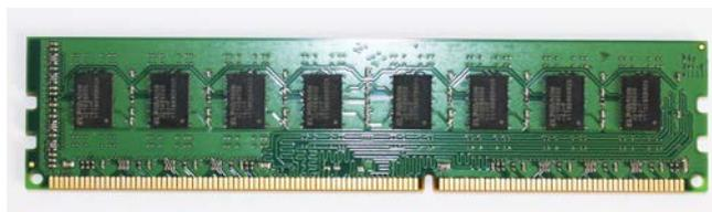
Existem 3 memórias RAM no mercado, basicamente: DDR, DDR2 e DDR3, sendo a DDR3 a mais potente no mercado atual. Cada um destes tipos de memória tem uma velocidade, medida em MHz. Atualmente existem memórias de 4GB, 8GB, 16GB e assim sucessivamente.
